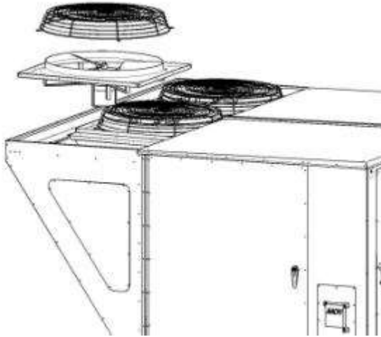
Figura 40 - Desmontaje del Ensamblaje del Ventilador del Condensador
