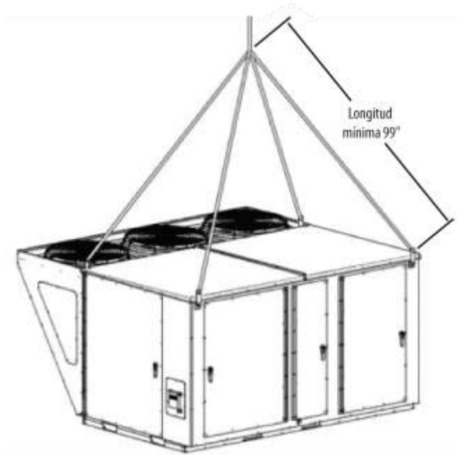
Figura 6 - Detalles para Alzar una Unidad de Extracción Estándar o Eléctrica de 6-25 y 30 toneladas
