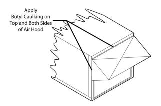
Figure 5 - 55-140 ton Open Rain Hood
